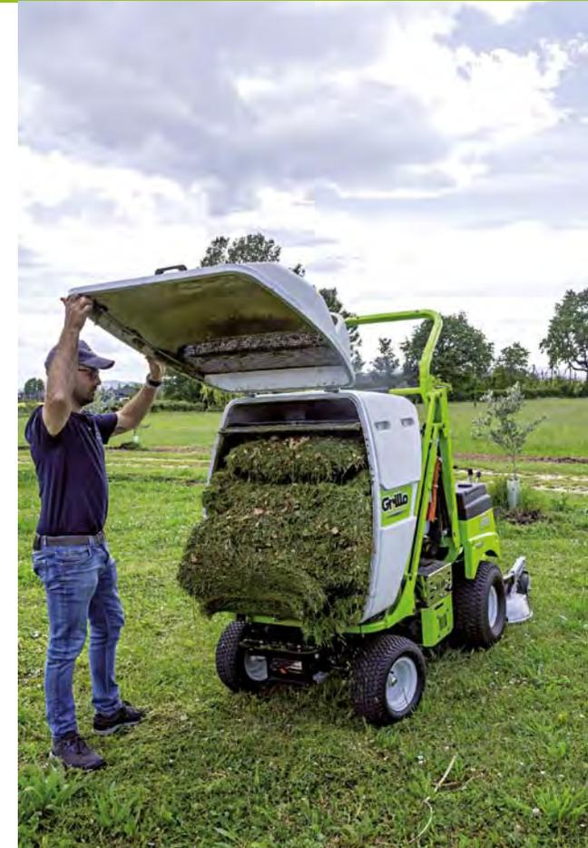
Die Bedienung der hydraulischen Dienste um den Fangkorb anzuheben oder zu kippen, erfolgt vom Fahrersitz durch bequeme Hebelsteuerung, welche die Arbeitsschritte des Entleerens des Fangkorbs und seine Rückführung in die Arbeitsposition fließend und schnell erledigt. Ein dritter Hebel erlaubt das hydraulische Anheben des Mähdecks um einfach Bordsteinkanten und Hindernisse zu überwinden.
