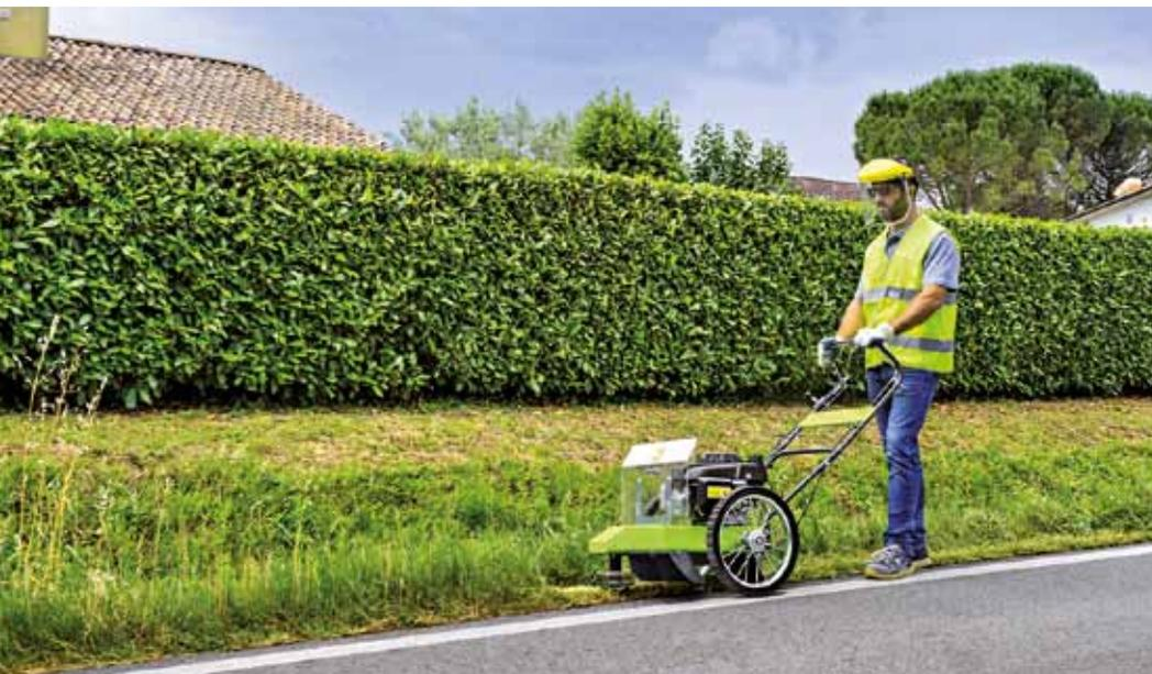
Der **HWT 600 WD** ist mit einem, 4-Takt Benzinmotor 166 cc, 4,8 PS. mit einem Getriebe mit Zahnradern in Ölbad sowie hoch widerstandsfähigen Riemen ausgestattet.
