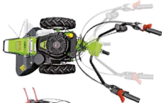
Die Räder mit Agrarbereifung gewährleisten eine optimale Bodenhaftung.
