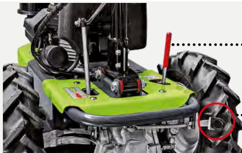
Er verfügt über eine Parkscheibenbremse, die in der Lage ist, die Maschine auch in Hanglage stabil zu halten.
