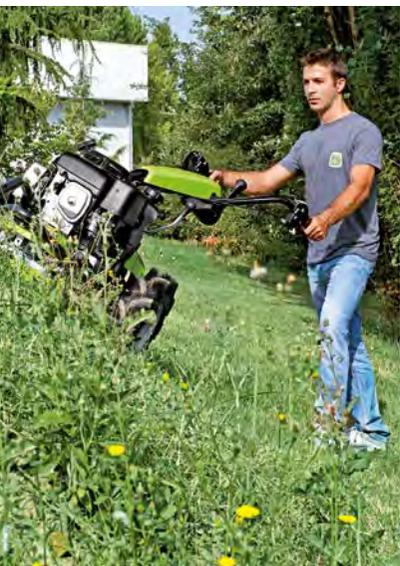
Beim Mähen entlang des Hangs ist es möglich, das Vorderrad zu blockieren, was die Arbeit erheblich erleichtert. Darüber hinaus ist der Motor mit einer **Ölpumpe** ausgestattet, die das Arbeiten in Hanglage erlaubt, ohne dass der Motor beschädigt wird.
