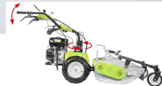
Zapfwelle mit Kupplung
