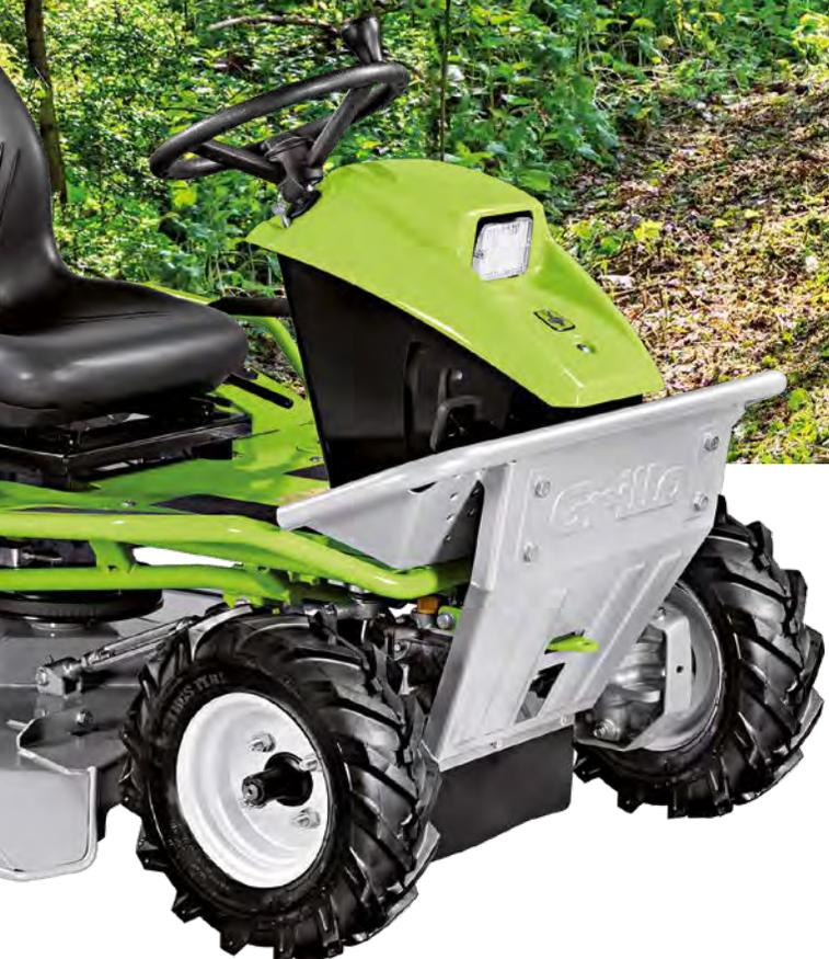
Die **Schnitthöhe** wird mit Hilfe eines Hebels eingestellt, mit automatischer Blockierung in jede Position. Bei Loslassen des Hebels bleibt das Mähdeck in der gewünschten Stellung. Durch **Bedienen des Schalters nahe dem Lenker wird das Messer eingekuppelt**. Die **elektromagnetische Kupplung** für die Messereinschaltung hat eine integrierte Messerbremse. Das Mähdeck mit einem Messer hat 93 cm Schnittbreite beim AWD 10.22 und 98 cm Schnittbreite beim AWD 10.27.
