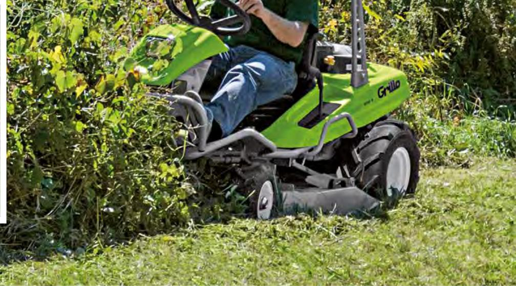
Die durch Pedal bedienbaren Trommel – Betriebsbremsen auf alle 4 Räder gewährleisten optimale Sicherheit auch beim bergabwärts Fahren und sind mit Schutzvorrichtungen zum Eindringen von Grashalmresten geschützt. Die Vorderräder sind serienmäßig mit **Anti-Pannen-Schutz** behandelt.
