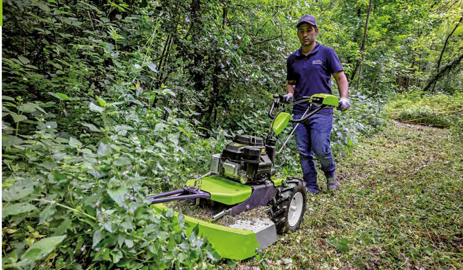
Der CL 62M ist mit einem FJ180V OHV Einzylinder Benzinmotor mit 179 cc Hubraum und 4.5 PS ausgestattet. Treibstofftank Fassungsvermögen: 1,6 L. Der Motor ist mit einer Ölpumpe ausgestattet, dies gewährleistet den Einsatz der Maschine an Hängen bis zu 30° Neigungswinkel.
