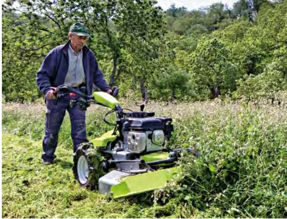
Der CL 75 verfügt über einen Benzinmotor Modell GXV 390. Der 1-Zylinder-Motor hat 389 cc Hubraum und hat moderne Lösungen, die dessen Zuverlässigkeit garantieren, wie z.B. oben liegende Ventile, **geringe Abgasemissionen, niedriger Verbrauch, hohe Leistungen und aufs Mindeste reduzierte Vibrationen.**
