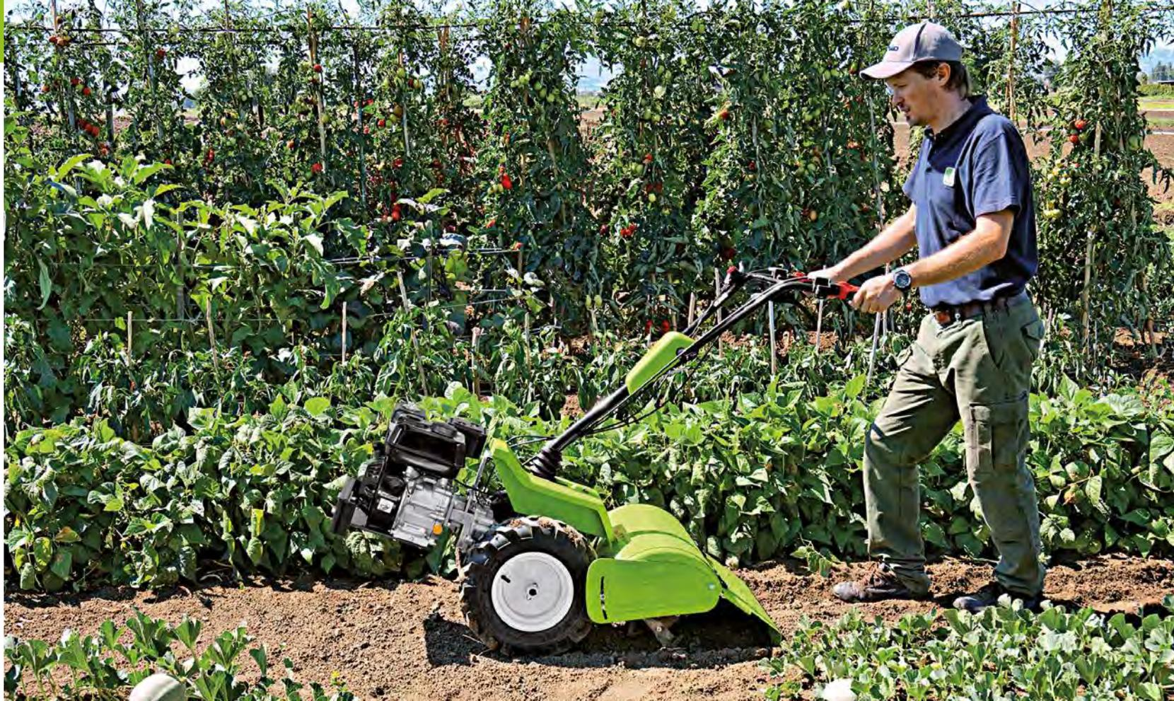
Der Einachsschlepper ist mit **Aktiv-Kupplung** ausgestattet: beim Loslassen des Hebels hält die Fräse an, der Motor läuft aber weiter. Der Antrieb und die Zapfwelle haben voneinander unabhängige Steuerungen. Eine **Sicherheitsvorrichtung** verhindert das Funktionieren der Fräse im Rückwärtsgang.
