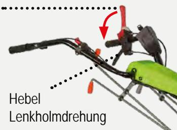
Die auf Bestellung erhältlichen **Bremsen** sind bei Arbeiten in Hanglage nützlich und begünstigen die Lenkung, insbesondere bei Anschluss von schwergewichtigem Zubehör wie Schlegelmäher oder rotierende Egge. Sie werden durch 2 Hebel am Lenkholm betätigt und sind mit Sperrvorrichtung ausgestattet, damit sie auch als Parkierbremse fungieren. Die Trommeln sind auf einer Drehbank gedreht, so ist ein genaues Abbremsen gewährleistet.
