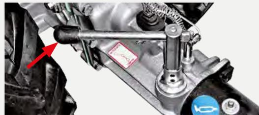
Der Antrieb erfolgt durch **Aktiv-Kupplung**: bei Loslassen des Hebels stoppt die Maschine, der Motor läuft aber weiter. Antrieb und Zapfwelle sind voneinander unabhängig. Eine **Sicherheitsvorrichtung** verhindert den Betrieb der Fräse bei eingelegtem Rückwärtsgang (mit hinten angeschlossenem Zubehör).
