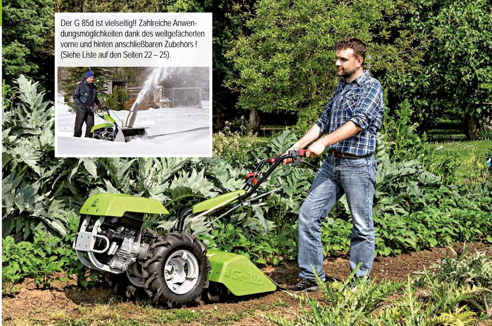
Der G 85d ist mit **Differentialsperre** ausgestattet. Diese Vorrichtung begünstigt die Handhabung der Maschine während des Transports und bei Manövern.
