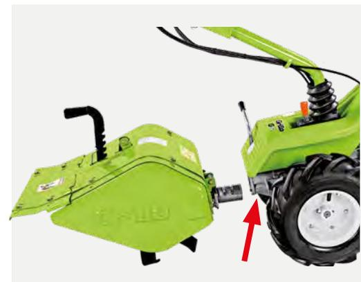
Der auf dem G 52 serienmäßig vorhandene **Schnellanschluss** erlaubt das rasche Auswechseln des Zubehörs. Zur Sperrung genügt ein einfaches Drehen des Hebels, es sind keine Schlüssel notwendig.
