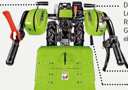
Der **Rückwärtsgangshebel** ist am Lenkholm angebracht. Bei Einlegen des Rückwärtsgangs schaltet sich automatisch die Geschwindigkeitsverringervorrichtung ein.
