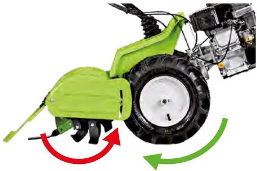
**Die Frästiefe** kann durch den Schlitten in 2 Stellungen eingestellt werden. Um eine höhere Frästiefe zu erlangen, ist das Abmontieren des Schlittens möglich.
