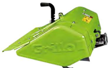
**Fräse mit doppeltem Rotationssinn.** Diese neue Fräse vereinigt die Vorteile einer Standardfräse mit der einer gegenläufigen Fräse. Mit Hilfe eines Hebels am Fräskasten kann man je nach Bedarf den Drehsinn der „schwingenden“ Hackmesser umkehren.
