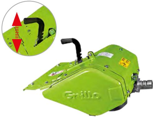
**Die Frästiefe** wird mit Hilfe eines außerhalb des Fräskastens angebrachten Hebels reguliert. Für ein besseres Ergebnis kann auch der **in der Mitte befindliche Sporn** je nach Bodenbeschaffenheit (hart, mittel und weich/sandig) in 3 Positionen reguliert werden.
