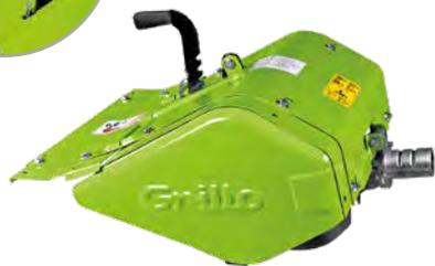
**Die Frästiefe** wird mit Hilfe eines außerhalb des Fräskastens angebrachten Hebels reguliert. Für ein besseres Ergebnis kann auch der **in der Mitte befindliche Sporn** je nach Bodenbeschaffenheit (hart, mittel und weich/sandig) in 3 Positionen reguliert werden.
