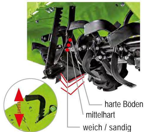
Die **Frästiefe** wird mit Hilfe eines außerhalb des Fräskastens angebrachten Hebels reguliert. Für ein besseres Ergebnis kann auch der **in der Mitte befindliche Sporn** je nach Bodenbeschaffenheit (hart, mittel und weich/sandig) in 3 Positionen reguliert werden.
