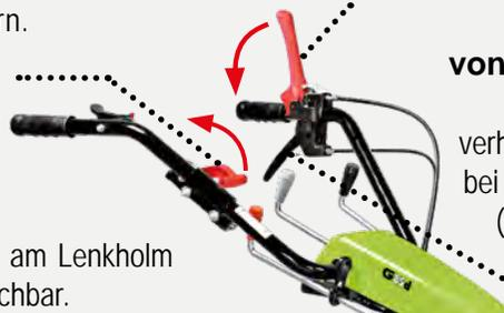
Die auf Bestellung erhältlichen **Bremsen** sind bei Arbeiten in Hanglage nützlich und begünstigen die Lenkung, insbesondere bei Anschluss von schwergewichtigem Zubehör, wie z.B. dem Schlegelmäher. Sie werden durch 2 Hebel am Lenkholm betätigt und sind mit Sperrvorrichtung ausgestattet, damit sie auch als Parkbremse benutzt werden können.
